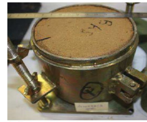
3. Eprouvette après essai
